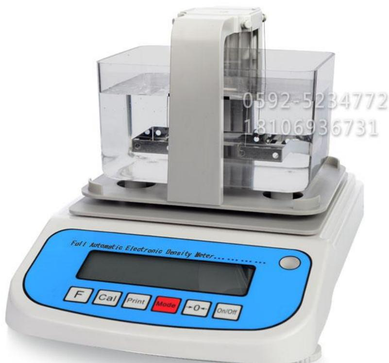
高精度固体密度计采用浸渍法密度测量方法是基于阿基米德定律(物体在浸渍液中所受到的浮力等于排除该物体同体积浸渍液的质量),将体积的测量转换为浮力的测量,即只要测得该物体全浸没在已知密度的浸渍液中的浮力大小,就能计算出该物体的体积。
