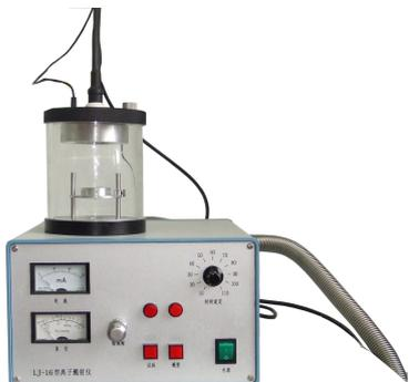
LJ-16 小型离子溅射仪由裕隆时代公司精心设计制造，是专用于扫描电镜（SEM）的样品喷金镀膜系统，能够极为有效的提高电镜观测效果。
