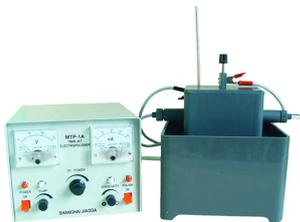
MTP-1A 电解双喷减薄仪是专用于透射电镜 (TEM) 的样品减薄系统, 能够极为迅速快捷的将样品减薄到纳米级厚度, 以适应透射电镜的观测需求。
