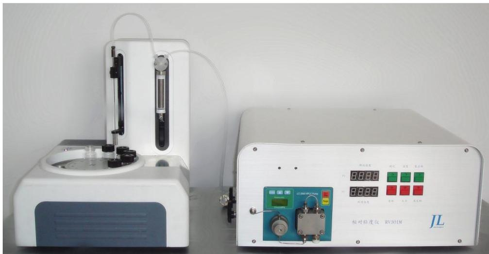
**RV300相对粘度仪**符合ASTM D 5225标准，适用于测定高分子稀溶液的相对粘度，它的工作原理是测定溶剂和样品溶液连续地受迫流过两根串联的不锈钢毛细管所分别产生的压降。
