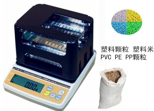
原理: 采用阿基米德原理, 操作简单方便、测量快速、结果精准、经久耐用、经济实惠等特点。符合 GB/T 533、ISO 2781、ASTM D 297、DIN 53479、ASTM D792、ISO 1183、GB/T1033 标准;
