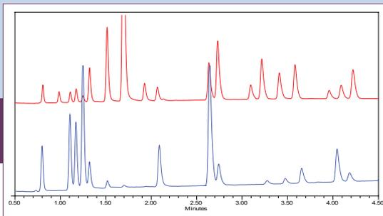
Altus UPLC® 不同凡响的流量精度和进样的精准性在上面重叠色谱图中有着完美的展示-连续10针进样的19种多环芳烃混合标准溶液色谱图。
