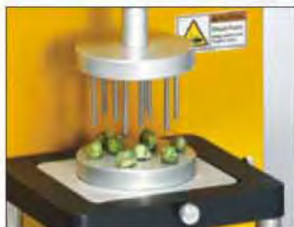
TA-JMPA 微型多探头夹具 由9个3mm 探头和相应底盘组成，可容纳固定9个诸如豌豆、谷粒、肉丁、重组肉块、馅料、坚果或者风干水果等不规则样品。
