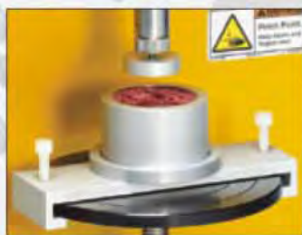
TA-BEC 后向挤出单元 适用于苹果酱、布丁、酸奶酪以及类似产品。
