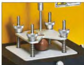
TA-CJ 穿刺固定夹具 用于固定糖果等物品来做穿透试验，预防当探头收回时样品被带起。
