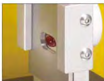
TA-BLS 双层剪切夹具 用于评估药片的性能，以确保吞咽时可控的溶解速度以及在产品包装过程中的强度。
