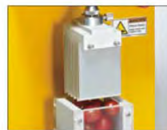
TA-KSC Kramer剪切单元 融剪切和挤出为一体的测试。细小的水果和蔬菜，如西红柿、葡萄、无花果、玉米、豆类、肉馅和馅料、膨化食品。
