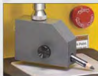
TA-EP 眼影笔夹具 模拟使用眼影笔所需的力，以及正常使用和包装/运输时眼影笔可承受的断裂强度。
