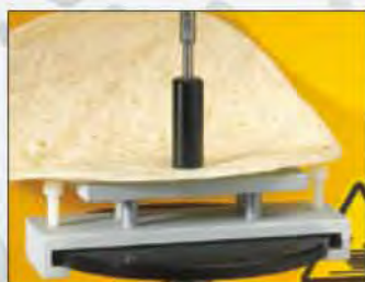
TA-JPA 微型冲击试验夹具 应用最大 12.7mm 直径的探头去小范围的冲击扁平样品。下面对应的夹具孔尺寸为14mm。
