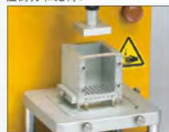
TA-OC Ottawa单元 用于通过两个可互换的基座之一来挤出各种柔软样品。非常适合于测试熟面食或菜丁和水果片。
