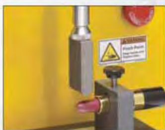
TA-LC 唇膏悬臂夹具 量化强度和内聚性，以确保产品在用户嘴唇上使用时无弯曲、无碎屑、不开裂和不折断。
