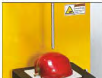
TA-MTP Magness-Taylor探头 用于测试新鲜水果和蔬菜的硬度。
