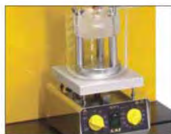
TA-MA Muco粘附夹具 通过模拟人体状态和温度，然后测量在适宜条件下药片破碎所需的力，从而量化药品对粘膜表面的附着力。
