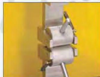
TA-RCA 滚轮夹具 用来测试包装材料、织物、聚合物薄膜等的拉伸性能。
