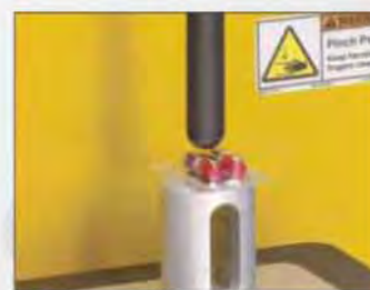
TA-BPS 吸塑包装支撑夹具 模仿人体手指挤压吸塑包装的行为，以确保从包装中取出产品时的完整性。
