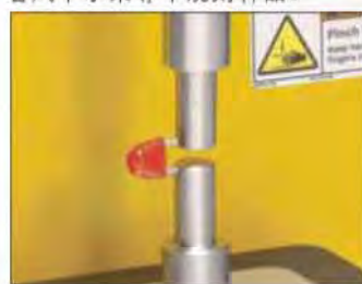
TA-CLT 胶囊环拉伸夹具 量化分裂硬胶囊所需的力，以及外壳的填充效果和胶囊的脆性/弹性。
