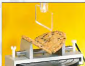
TA-JTPB 微型三点弯曲夹具 配合标准探头箱中的TA7刀片探头使用。
