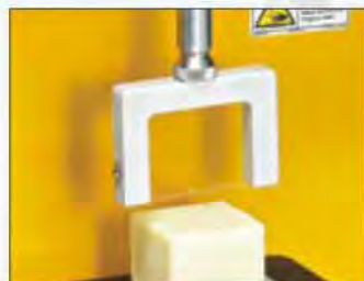
TA-WSP 线性剪切平板夹具 允许切割线完整切过样品。适合于测量带有一定粘性的产品，如奶酪和黄油。
