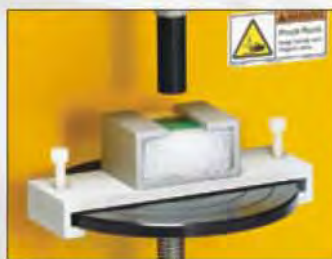
TA-ATT 胶粘剂粘性试验夹具 测量压敏性粘性物料，如磁带。
