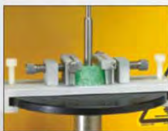
TA-AVJ 可调节固定夹具 固定穿刺试验的小样品，尤其适合于果冻/豆类/坚果等。
