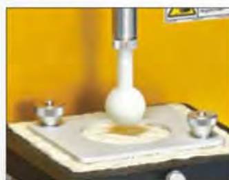
TA-DE 生面团延展性夹具 用于固定一层生面团或扁平制品，如玉米粉圆饼。二轴性测试应力由球型探头施加。当样品被拉伸至转换点时，测试将获得对应的力和距离。
