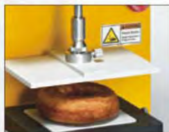
TA-CTP 压缩平板单元 可施加一个均匀压缩的力于样品。样品尺寸可达4x6英寸(10x15cm)。
