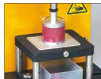
TA-DEC 双向挤出单元 可前后两个方向挤出泥/奶酪布丁以及类似产品。
