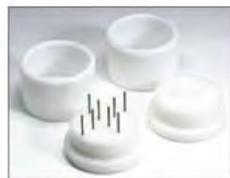
TA-FMBRA FMBRA 生面团罐套装附件用于制备生面团样品，并测定生面团的坚韧性。
