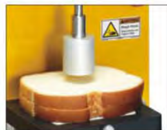
TA-AACC36 AACC 标准探头 测试面包坚韧性以及TPA分析。
