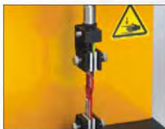
TA-DGA 双向拉伸夹具 用于上下钳制薄膜或包装材料以便做拉伸测试。
