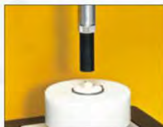
TA-DSJ 生面团粘性夹具 生面团粘性测试的标准夹具，该粘性为处理生面团过程中的一个最重要参数。
