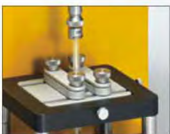
TA-STJ 注射测试夹具 用于测量推动或拔出注射型活塞所需的力。尤其适用于预填充的注射市场或自制注射产品的厂家。
