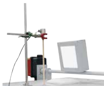
作为附加装备的排气门和带支架的炉料热电偶
