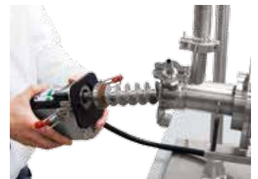
转速可调节式螺旋输送机
