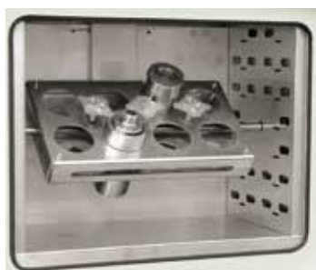
电动旋转装置作为额外装置
