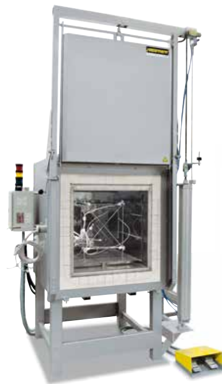
用来测量温度均匀性的测量架
