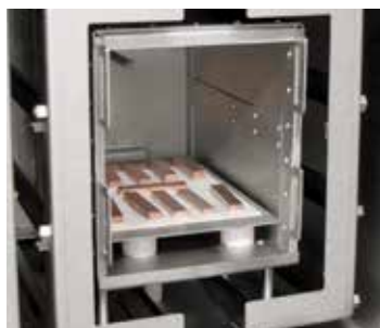
在氢气环境下，在 VHT 08/16 MO 炉型内对铜棒进行热处理
