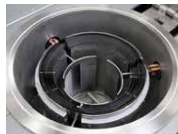
带钨丝加热装置的圆柱形气密罐
