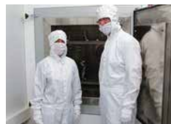
N 250/65 HAC 型循环空气炉，级别为100的无菌室结构型式，炉门位于无菌室内
