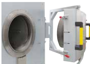
附加的平行回转门，用来在高温状态下打开炉门
