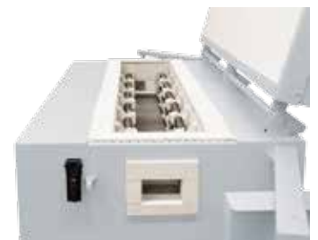
可为GR 1300/13的炉膛额外选装两扇炉门
