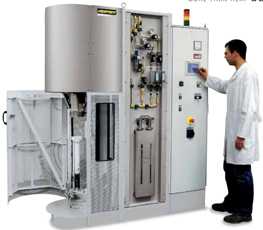
RHTV 120/480/16 LBS 带有一端封闭的工作管，可选配保护气体和真空以及升降台的电子转轴驱动装置
