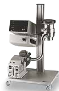
真空泵工作站的最终压力可达10 -5 mbar
