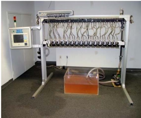
大型板材生产线高速并行板刷探头超声波质量控制
