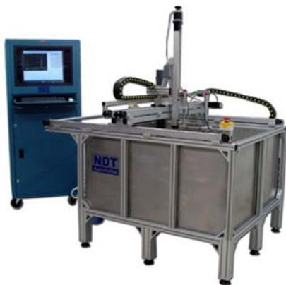
高速、高精度、不锈钢水槽航空航天零部件扫查系统
