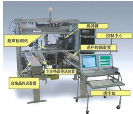
自动上下料的炮弹壳底座自动超声质量检测系统
