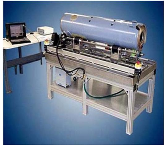
导弹类柱状零件喷水式超声扫查系统
