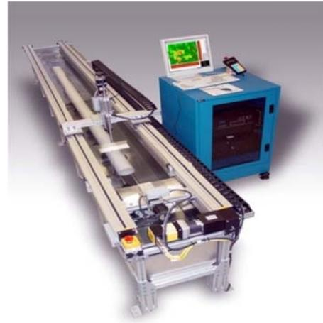
带驱动滚轴的轴、管类零部件扫查系统
