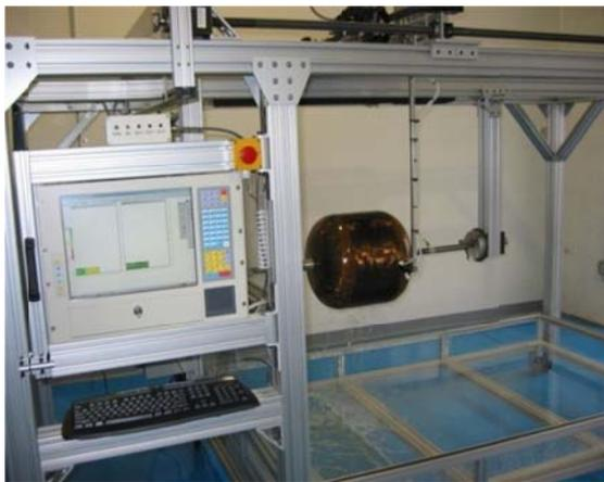
大型桁架结构曲面跟踪超声扫查系统
