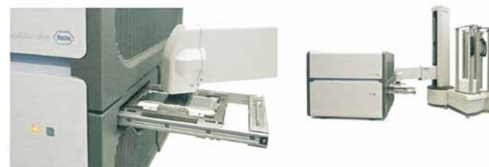
▲ 图 9: LightCycler® 480 II系统自动化装板过程。
