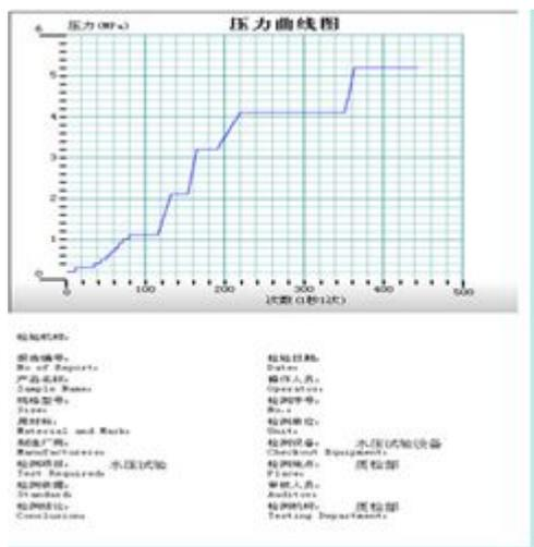
压力容器试验台，数据采集软件
