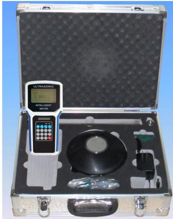
便携式超声波测深仪是测量水库、湖泊、江河、浅海等水体的便携式测深仪，测深时将超声波换能器置于水面或一定位置，利用超声波在水中的固定声速  $V$  和超声波发射到接收的时间  $T$ ，仪器自动换算出水深  $H$ 。仪器可在静水中测深，也可在具有一定速度的水中测深；水流速度可达 5m/秒左右，是水文测验、水电厂、库区、湖泊、河道勘测和环境水域监测的理想水深测量仪器。具有测量精确、耗电省、可靠性高、使用方便、操作简单、测量速度准确、携带方便等优点。
