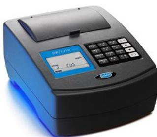
哈希公司的 DR1010 便携式 COD 测定仪是专门根据中国用户的水质情况、使用习惯以及法规要求而开发的一款光度法 COD 快速测定仪，满足实验室的日常测定要求，同时支持现场测定。该便携式 COD 快速测定仪符合环保系统快速消解分光光度法 COD 测定标准的要求，同时支持哈希公司经典的 2 小时消解 COD 测定方法。便携式 COD 快速测定仪内置标准 COD 测试曲线并支持用户自建曲线。DR1010 便携式 COD 快速测定仪秉承哈希公司一贯严谨的产品开发风格，具有符合标准、高精度、高使用灵活性的特点。
