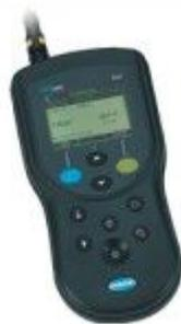
HQ30d 便携式溶解氧测定仪是哈希公司采用最新技术开发而成，适合于实验室和野外测试的两款便携式仪器。
