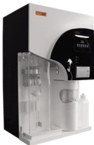
K9860 全自动凯氏定氮仪适用于快速、准确和灵活多样的蛋白质及含氮量的全自动分析。专利隔膜式气泵和特制无故障电磁阀使核心部件使用寿命更加长久。滴定系统采用世界权威组织认证的颜色判定终点法，避免使用电极需要频繁更换及校正的繁琐过程，蒸馏、滴定、结果计算及打印过程一体完成。通过仪器窗口的操作和观测，用户可以毫不费力地得到实验数据和打印结果。
