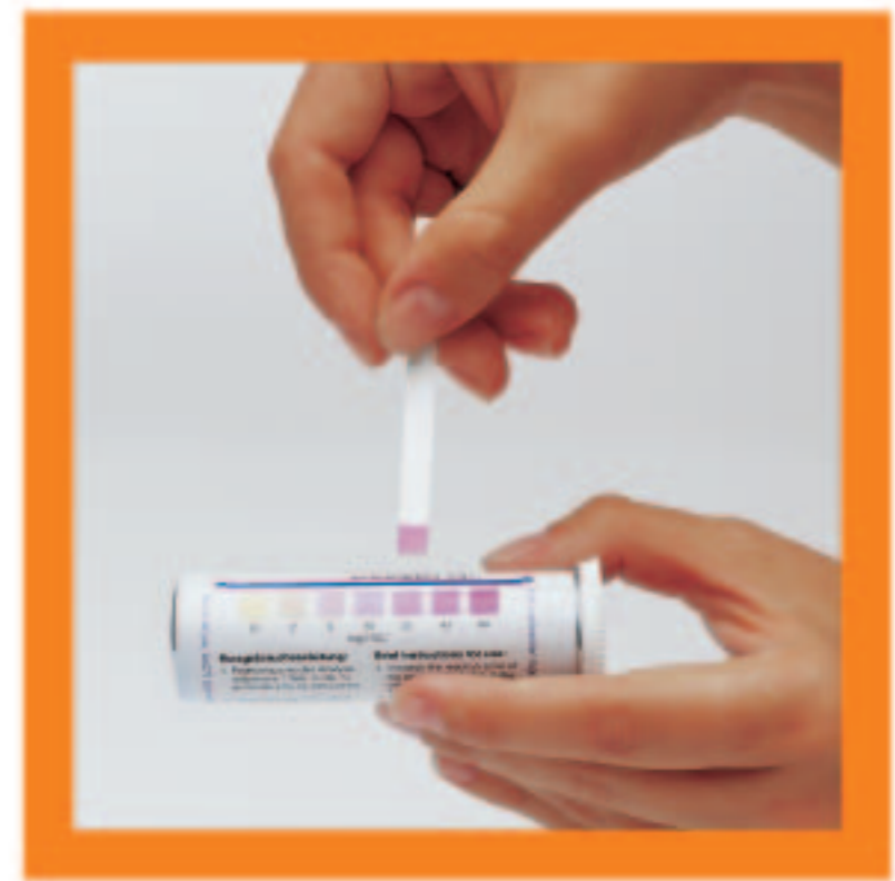
3. 等待一定的反应时间后(一般为一分钟)，将试纸反应区和测试条包装筒上的色卡进行比对得到读数。
