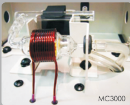
射频线圈包围在石英浓缩池的外面，位于光路中吸收池的前面
