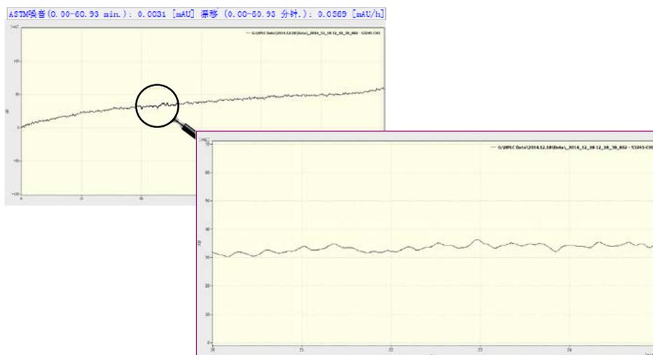
图 20 检测器噪声漂移实测图
