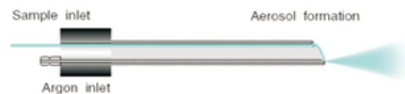
V型雾化器适合于高盐样品的分析
