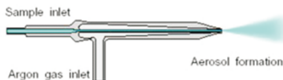
标配的同心轴雾化器可以满足大多数使用要求
