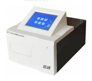
KF-1601A 酶标分析仪采用嵌入式电脑控制技术,备有8条光通道,具有自动进板、自动测量、自动进行数据分析处理,并可根据操作者要求有选择的打印数据,仪器内置四片标准滤光片,测量时可根据操作者的设定自动识别进行单、双波长测量。仪器采用大屏幕液晶显示,触摸屏输入。
