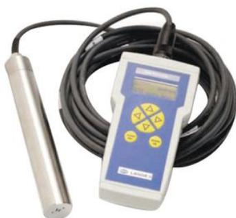
TSS Portable 便携式浊度、悬浮物和污泥界面监测仪在市政和工业废水、饮用水以及河流监测中是一种非常理想的远程监测工具。该仪器可以用做监测过程中的一种优化工具，也可以作为校准或验证在线传感器的一种简便方法。
