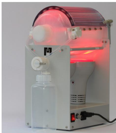
做原子吸收、ICP-OES和ICP-MS分析时，通常需要超纯酸，但是超纯酸非常昂贵。现在为您提供一个省钱的解决方案：使用这套酸纯化器，您可以得到超纯的酸和水
