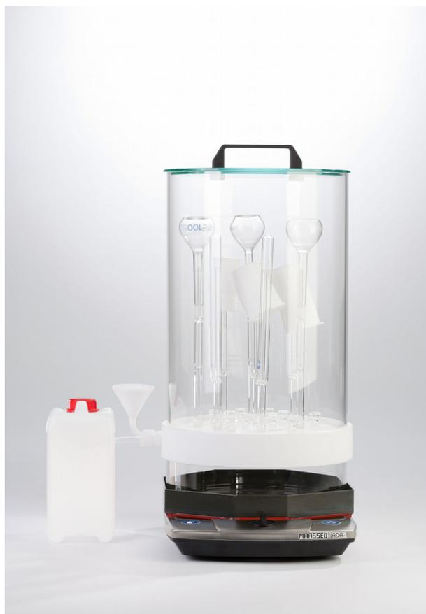
利用亚沸的蒸馏水或硝酸的热蒸汽来清洗反应管、烧杯、容量瓶等。
