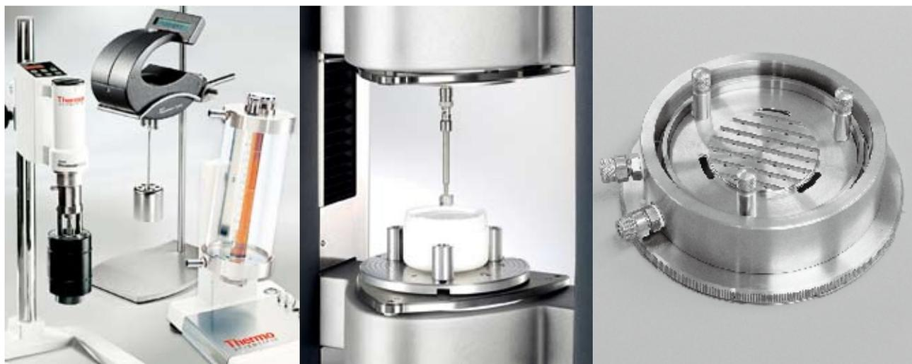
针对原料评估和批量试验，选择落球式和旋转式粘度计来进行快速、可靠的测量。
