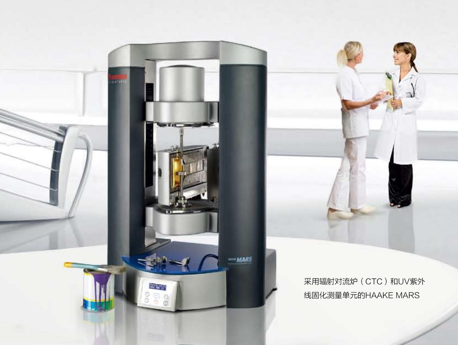
采用辐射对流炉（CTC）和UV紫外线固化测量单元的HAAKE MARS
