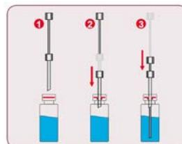
图 16 Z 轴双驱动进样示意图
