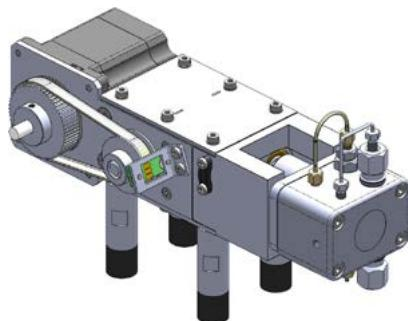
图 8 高压输液泵主体
