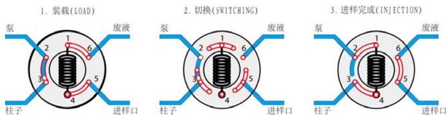
图 13 不断流 NFI 技术示意图
