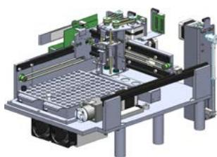
图 15 自动进样器结构图
