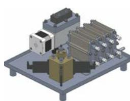
图 10 比例阀与在线脱气机
