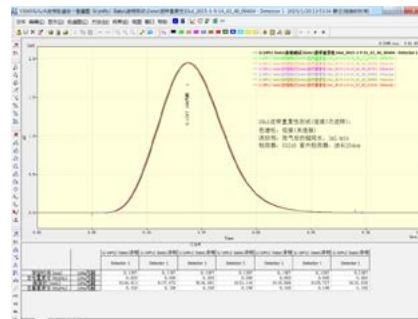
图 14 进样重复性实测图
