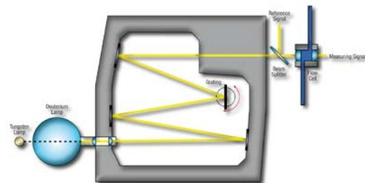
图 19 UV/Vis 检测器光路图
