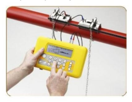
PF300plus/PF204plus/PF216plus 便携式超声波流量计是一种时差式的超声波流量计,用夹钳式传感器获取信号,可精确测量封闭管内的液体流量,而无需向管壁中插入任何机械部件或侵入到液体流动系统中。测量只需几分钟安装,无需关闭流量或排出管内液体。当超声波在两个传感器之间传播时,超声波的传播速度在通过液体时被在管中流动的液体流速而轻微加速,当超声波传播的方向与液体流速相反时,则液体的流速会引起传播声波的减速。两者之间的时间差刚好与管中的流速成正比。在测量完流速后,如果知道管道的截面积,就可以容易地计算出流量值。
