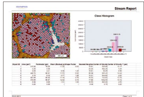
用魔杖工具进行测量的结果 ** (铸铁) ** OLYMPUS Stream Essentials或更高级的软件包
