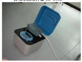
KF-808D 自动水质采样器,是我公司推出的用于地表水和污水采样、对水源进行监测、开展污染源调查及总量控制的专用环境监测仪器。它采用国际上通用的蠕动泵取水方式,由单片机控制工作。可根据用户需要采集等比例混合水样和等时混合水样。KF-808D 采用标准的 12V 锂电池工作,在野外工作电量不够时,可用汽车电瓶来替代。选配流量传感器时,同时计量流量,并将所测流量数据和采样情况存储起来,存储的内容掉电不丢失,事后可查阅。是各级环境监测、监理站进行水污染监测工作和环保科研部门开展研究工作的必备仪器之一。
