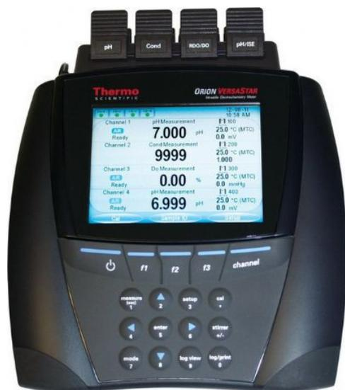
VM-01 台式多参数测量仪该仪器具有大尺寸、彩色 LCD 屏幕，可同时显示读数、通道、时间、日期、样品编号、用户编号和校准信息。
