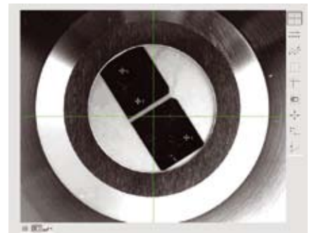
全景摄像头允许您观察整个试样并通过点击鼠标确定测试点位置
