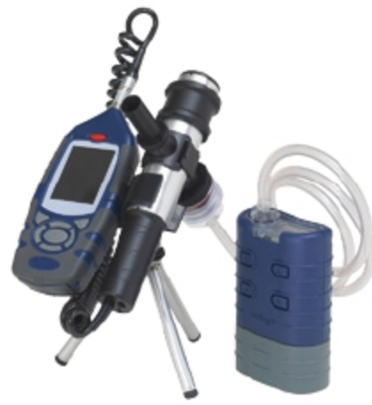
特定粉尘类型的校准因数的称重法测定
