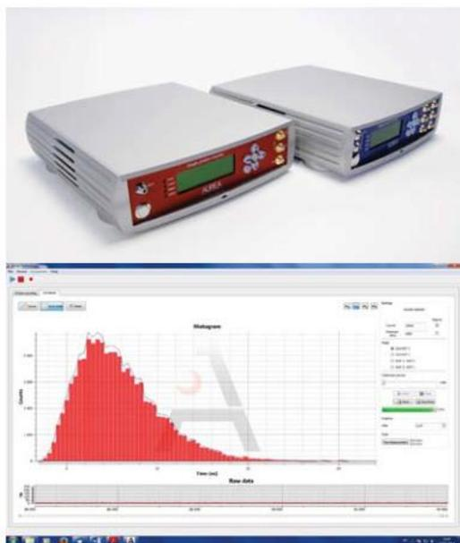
**LynXéa** 新一代一体化高性能时间相关单光子计数器 ( TCSPC )，是寿命测量、时间分辨和符合计数领域的近红外光单光子级别快速计数的理想解决方案。
