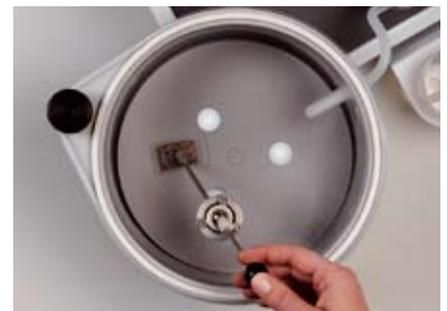
制作薄片试样的粘贴用盖子
