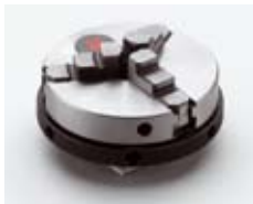
三爪卡盘 用于居中和夹持圆柱形工件，最大工件直径为65 mm
