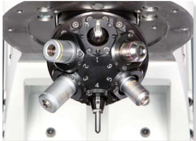
6位转塔台（可选配）——在应用多种测试方法时推荐使用 DuraVision可自动选择最佳的镜头
