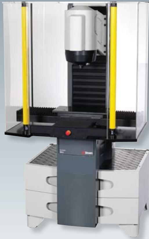
DuraVision-250/-350/-450设计用于在整个宏观测试载荷范围内（1-3000 kgf）对测试序列进行全自动硬度测试。基于直观的ecos Workflow™软件，本机器成为大型样品CHD测量、大型焊缝自动硬度测试及大型样品自动端淬测试或多个硬度测试的理想手段。
