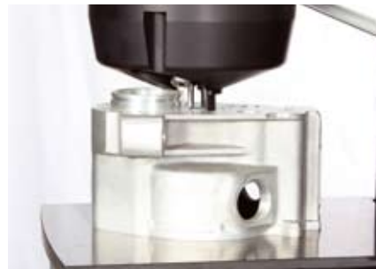
使用一个鼻锥插件的测试。 已取下一个鼻锥插件以方便地到达测试点，余下的一个鼻锥插件仍然提供了对试样的良好夹持。
