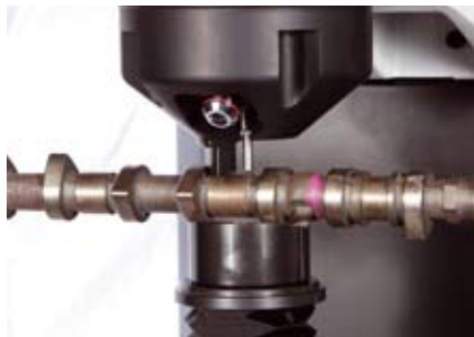
使用一个鼻锥插件的测试。 已取下一个鼻锥插件以方便地到达测试点，余下的一个鼻锥插件仍然提供了对试样的良好夹持。
