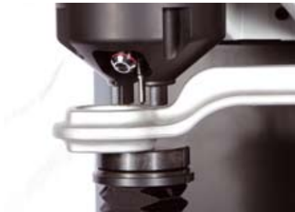
使用两个鼻锥插件的测试。 常规测试。均已安装了两个鼻锥插件。
