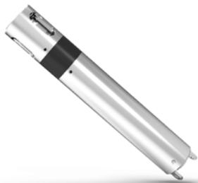
PLOC-200是一种针对地表水（地下水、井水）水资源保护而设计的原位连续监测的多指标在线监测设备。集成了pH、电导、温度、液位等传感器，包含供电单元、控制和数据采集单元、远程无线传输单元，通过特殊的结构设计，经精密加工而成。该传感器维护简单方便，抗干扰能力强。
