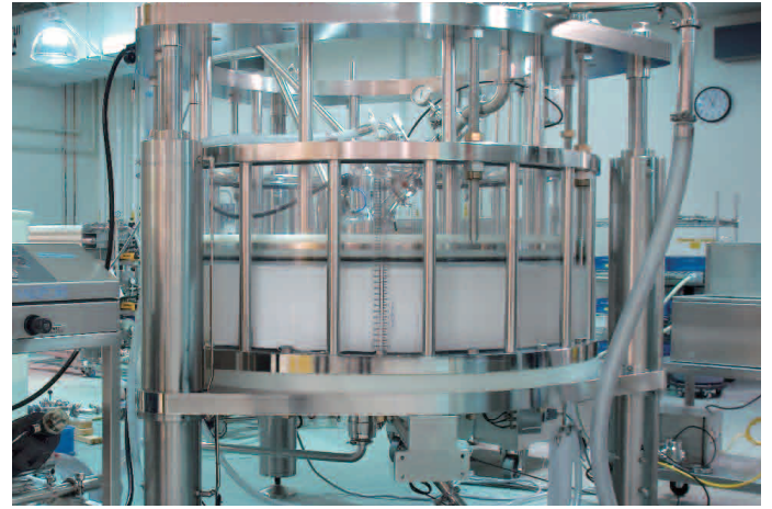
填充 ProSep 介质的大容量层析柱(柱直径1.6m)
