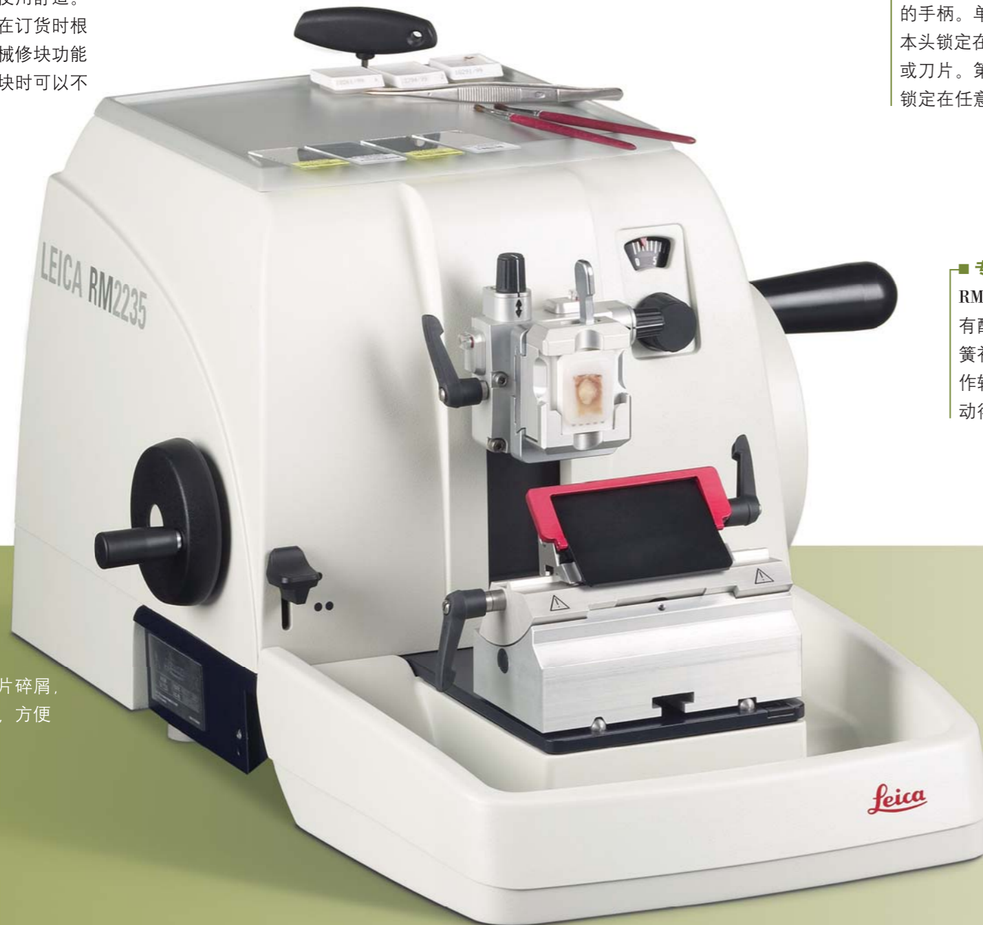
徕卡专利： 基于弹簧原理的力平衡系统
