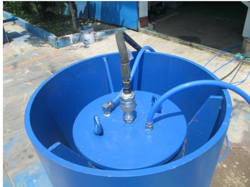
气瓶外测法水压测试台
