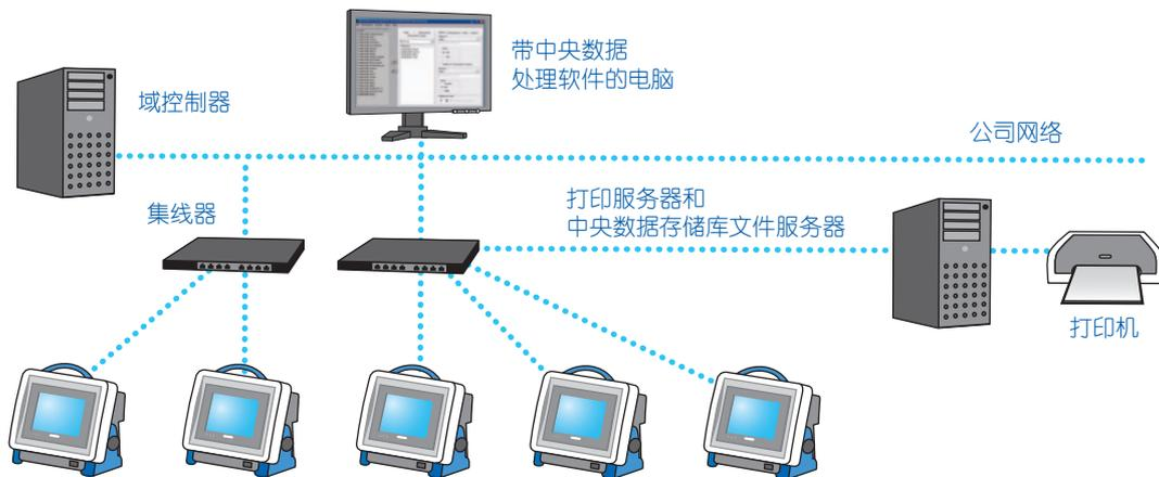
图 2: Integritest 4N 可与域控制的局域网 (LAN) 实现联网
