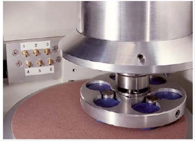
BuehlerVanguard® 2000系统为试验人员提供了单点力和中心力两种加载模式的试样制备方法。单点力加载模式下可实现一次只制备一个试样或同时制备多达6个试样。单点力加载模式下，试验人员可随时卸下某单个或多个试样用于检查分析，然后再重新用夹具装载好继续进行试样制备操作。
