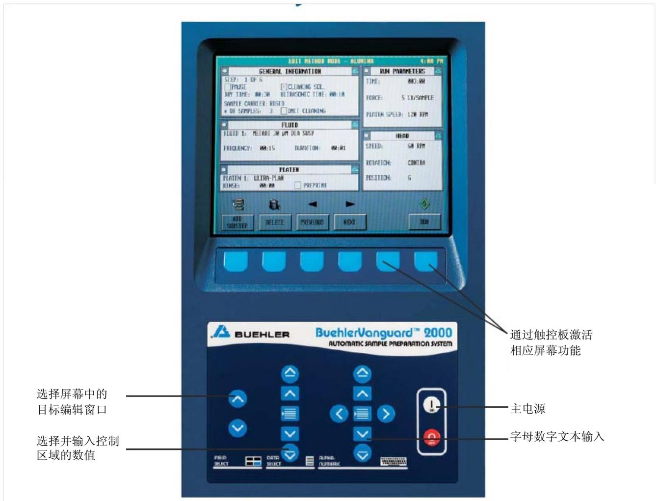
简明性是BuehlerVanguard® 2000系统之所以简单易用的关键因素。对于大多数的试样制备应用，试验人员仅需按下主电源按钮，滚动并选择所需的试样制备方法，然后按下“启动”按钮便可开始试样制备过程。制样方法程序启动后，机械手臂会自动从6个磨抛盘中将选定的磨抛盘装载到磨抛机座上；然后，在运行单点力或中心力加载模式时，自动化动力头再将试样装载到磨抛盘上。
