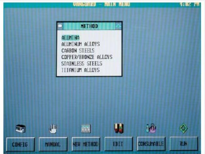
BuehlerVanguard®2000系统具有六种预安装的制样方法程序，适用于铝、铝合金、碳钢、铜/青铜合金、不锈钢以及钛合金等材料。用户可对这些方法进行编程、修改和另存为其他名称等操作。
