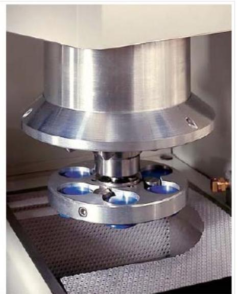
机械手臂将铝制磨抛盘从存放架移送至驱动基座。磨料悬浮液从6个自动清洗式喷嘴中的一个配送至试样制备台。
