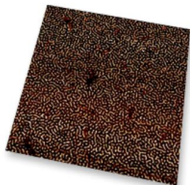
闭环模式下的相位图展现了聚烯(苯乙烯-b-丁二烯-b-苯乙烯)三嵌段共聚物的微相分离。图寸: 2 μm。
