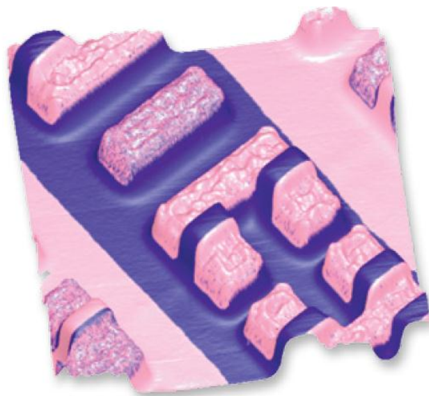
使用Dark Lift扫描电容显微镜获得精确的SRAM样品二维掺杂图像。图像尺寸：15 μm。
