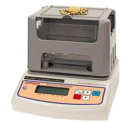
型號 Model KBD-300KY 秤重範圍 Weighing Precision 0.01g~300g 比重精度 Density Precision 0.001 g/cm3 可測量範圍 Sample weight range 5-300g
