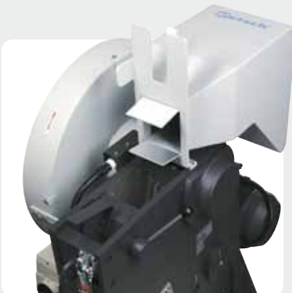
BB200的进料漏斗可翻起，样品直接进入粉碎腔。
