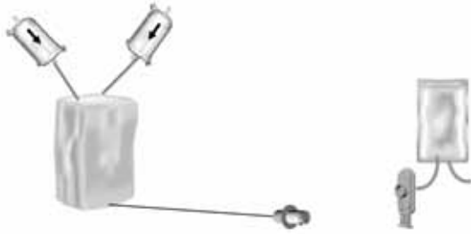
用途 4：加有铝胶或其他佐剂的无菌制剂，乳状（不能除菌过滤），无菌转移到制袋
