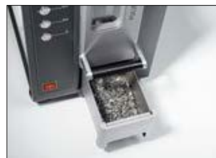
PULVERISETTE 1 premium line系列颚式破碎机用于破碎铁基合金-采用6.5mm的研磨间隙
