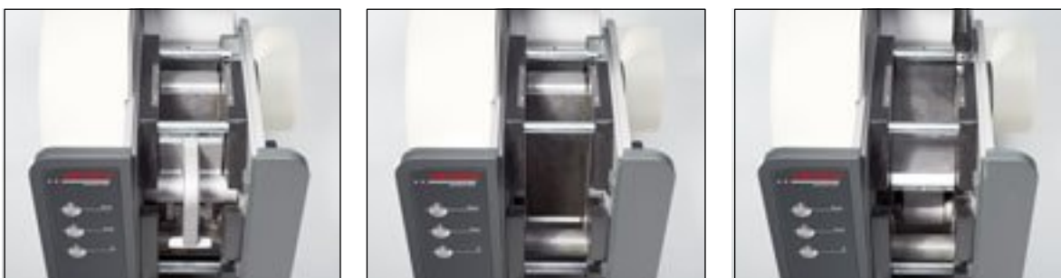
简单的清洗过程：移开固定式破碎板，向上翻转可移动式破碎板，即可以彻底的清洗研磨仓了！
