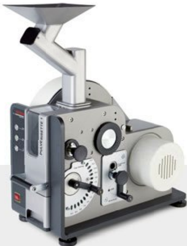
PULVERISETTE 1 premium line系列颚式破碎机用于破碎铁基合金-采用6.5mm的研磨间隙
