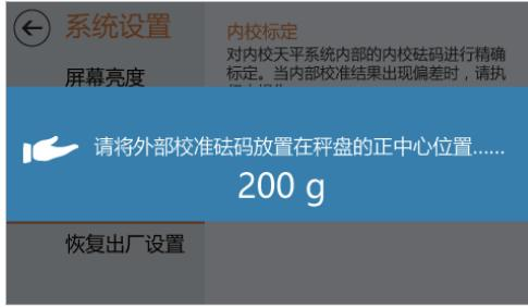
► 根据提示将外部校准砝码放置在秤盘的正中心位置。
