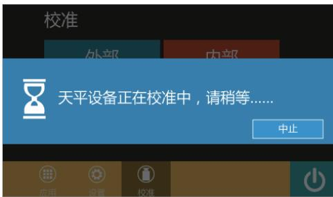
► 校准砝码从秤盘上移除后，天平开始自动校准。
