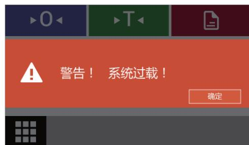
天平内部检测到加载物体超过最大量程：
