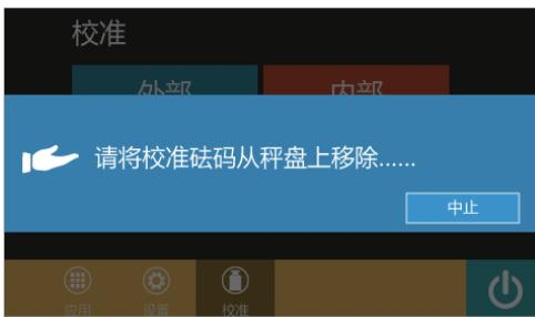
► 根据提示将校准砝码从秤盘上移除。
