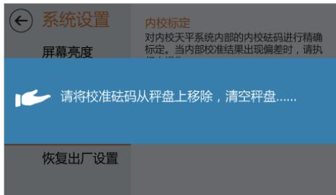
► 根据提示将校准砝码从秤盘上移除，清空秤盘。
