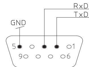
每台天平都可以通过 RS-232C 接口与外围设备连接（例如：RS-232C 串口打印机或具有 9 针插头的微机）。将天平与打印机连接起来，按照打印机的参数设置后即可选择  输出称量结果。
