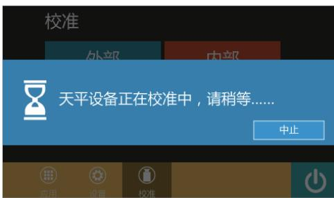
► 将校准砝码放到秤盘上后，天平开始自动校准。
