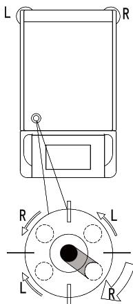
通过调节天平后端的水平调节脚，调节天平平衡，使水平仪内的水平泡正好位于圆环的中央。（如右图所示）
