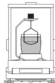
▶ 将被测固体物质放在处于密度称量工具之上的秤盘上。
