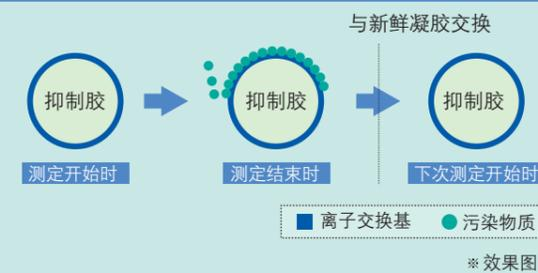
凝胶抑制方式是根据自动进样器的进样时间，自动地进行抑制胶的交换。抑制胶由于每次测定时都会被新的凝胶所替换，因此不会受到样品中污染物质所带来的影响。即使在所有的样品处理后，每一次都可以获得稳定的基线分离。
