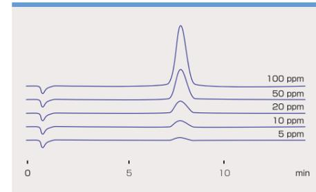
色谱柱: TSKgel IC-Anion-PW<sub>XL</sub> (4.6 mmID, ×3.5 cm, PEEK)
