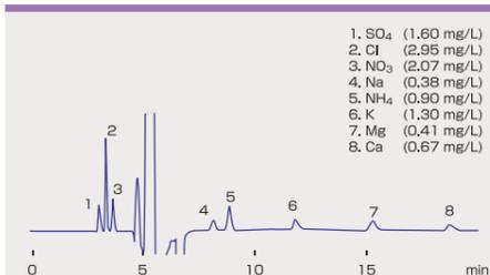
色谱柱: TSKgel SuperC-A/C (6.0 mmID, ×15 cm, SUS)
