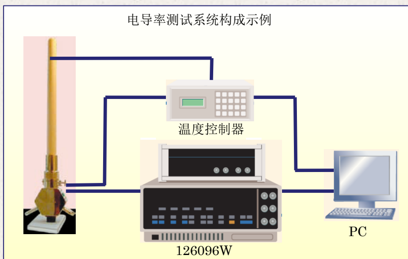
固体电解质的温度依存性实验 (500° C至1000° C之间 每100° C进行自动测定)
