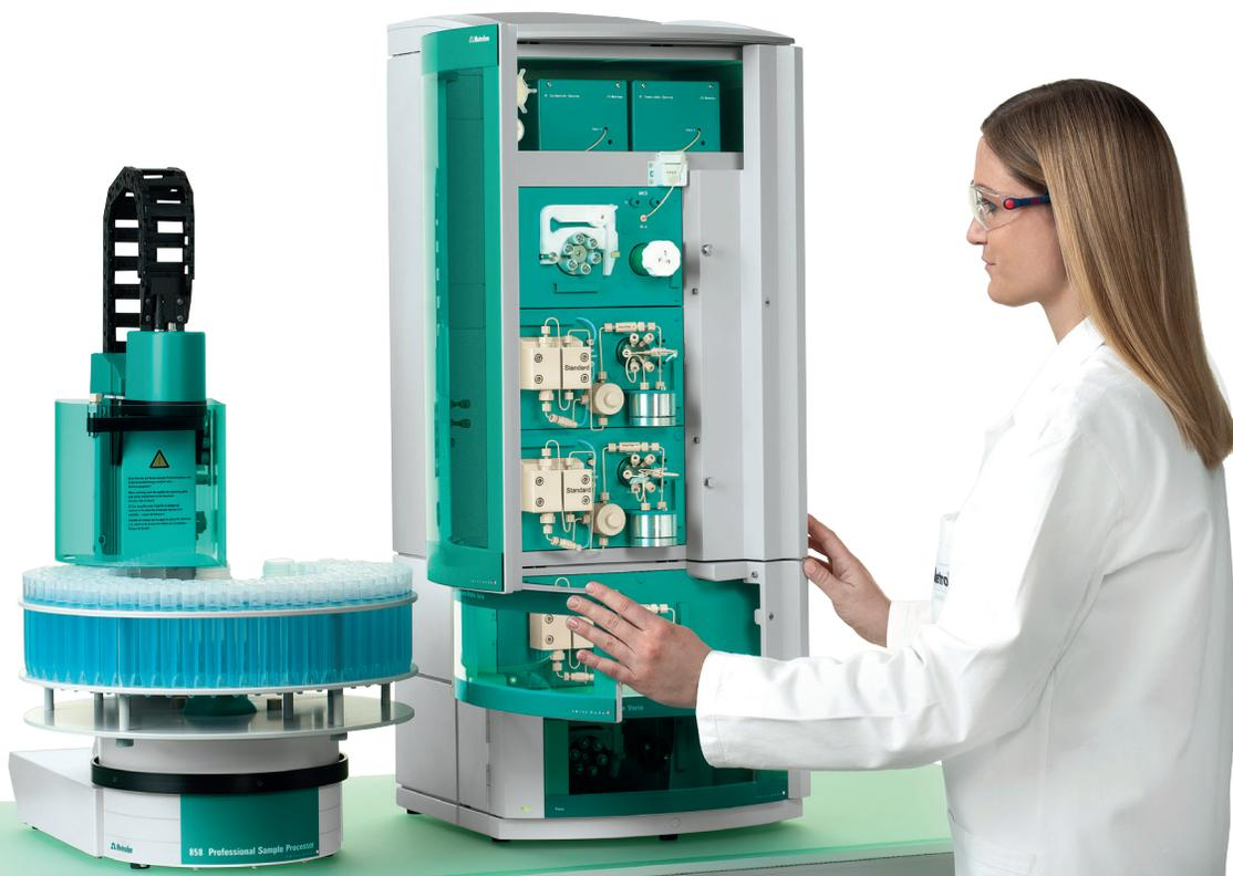
几乎所有的实际样品在进行分析之前均需要进行样品前处理。通过搭配不同类型的瑞士万通英蓝样品前处理模块《MISP》。940系列谱峰思维™离子色谱可实现不同样品的全自动在线前处理操作，例如超滤、稀释、渗析和预浓缩处理。
