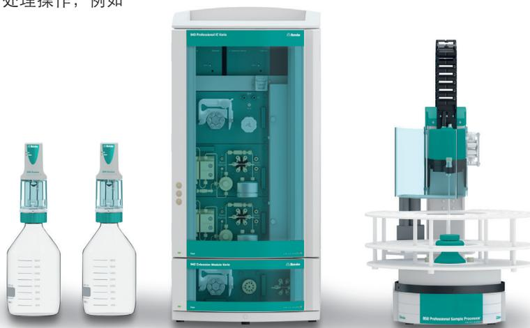
通过与942系列离子色谱功能拓展模块的灵活搭配，940系列谱峰思维™离子色谱可实现分析通路的升级和高压梯度的升级。例如，除了常规的阴-阳离子双通道系统外，通过系统升级，还可实现阴-阴离子双通道系统的升级。显然，这样的升级会使离子色谱的分析效率加倍。
